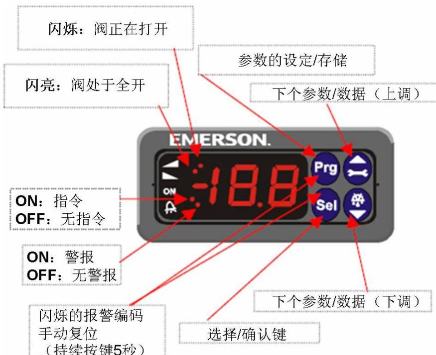
可以通过面板上的 4 个按键来设定及修改参数。已设定及修改的参数可以使用密码保护。初始秘密为“12”。
